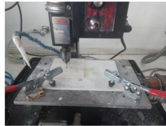
粘贴样品的树脂陶瓷放置到样品台上
