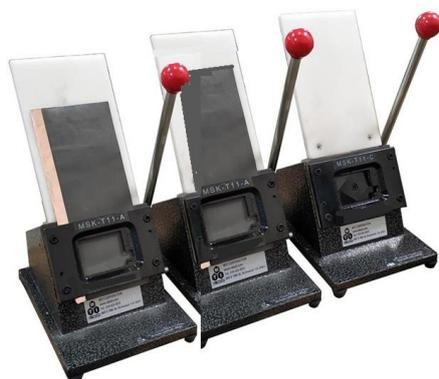
MSK-T-3 是一套手动软包电池切片机(三台切片机为一套)，用于合肥科晶可拆卸快速组装软包电池材料测试装置隔膜与极片的裁切，非常适合低成本的单层软包电池研发
