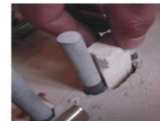
(7) 更换新棒时，氧化铝塞块与硅钼棒同时放入棒槽底部
