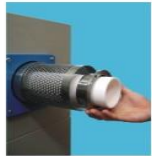
1. 将内法兰套在炉管上, 炉管超出压盖一定长度
