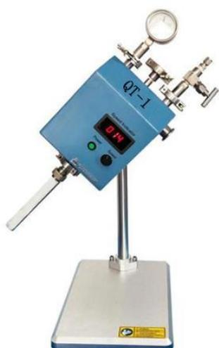
QT-1 是一个旋转真空封装机，可把样品封装在真空或气氛保护环境下的石英管内，防止样品氧化或燃烧。此款设备特别适合制备热电材料和生长对空气敏感而且易挥发材料的单晶
