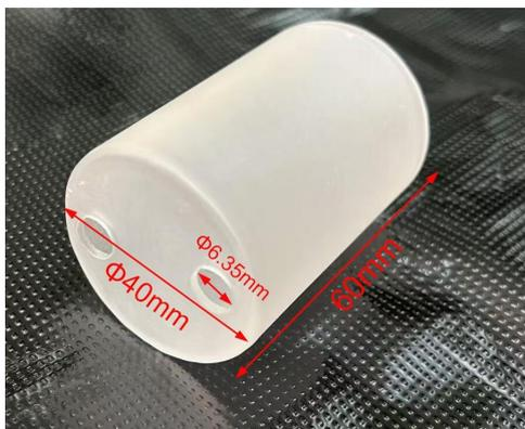
合肥科晶为高温管式炉（<1200℃）提供高质量石英管堵。相对于传统的陶瓷管堵，它不会对真空环境造成影响的同时提供一个洁净的真空腔体环境，该管堵带有通孔，用于插入气管以及测温热电偶。
