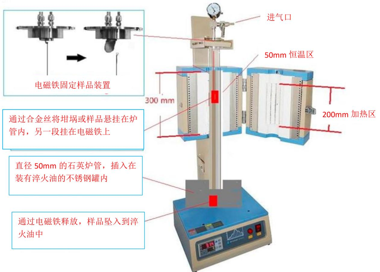
VT-1200X-50 是一款小型的淬火炉，配有直径为 50mm 石英炉管，最高温度可达 1200℃。一个电磁铁固定装置安装在顶部法兰内侧用于挂样品或坩埚，将样品置于炉体加热区中心。电磁铁可自动释放样品坠入到淬火油中。石英管底部插入到装满淬火油的不锈钢罐中，通过通入惰性流动气氛保证气密环境下淬火。
