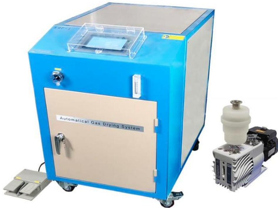
**RMP-1** 一款自动气体净化系统，可去除气体中的水可氧，为工作腔体提供一个低水氧的环境，可将手套箱内惰性气体的水氧含量降低至 **1PPM**。
