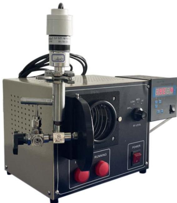
PDC-36G 型清洗机是一款清洗腔室尺寸为 $\Phi 3'' \times 6.5''$  L 的等离子清洗机，用于清洗基片或晶体上的纳米级的有机污染物，常用的清洗气体有空气、氧气、氩气，在高频“High RF”状态下最大去除污染物的速度为 20nm/min。它是一款很好的清洗工作，在做外延沉积之前对单晶衬底进行清洗能够达到更好的沉积效果。
