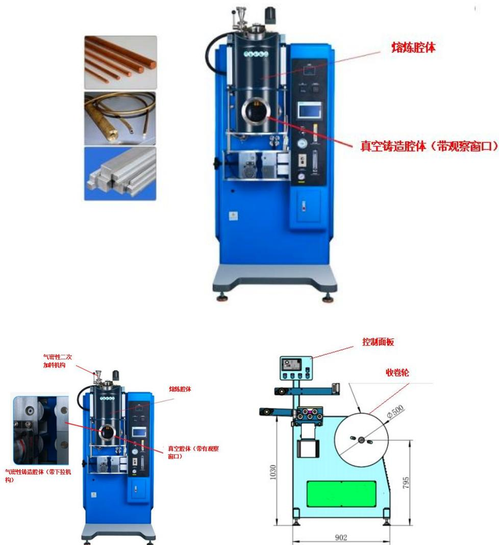
IMCS-1700VC 是一款感应熔炼/连续铸造炉（真空或惰性气氛环境），可连续铸造棒，板或管材，最高温度可达 1700°C，最大处理量 5kg（按不锈钢计算）
