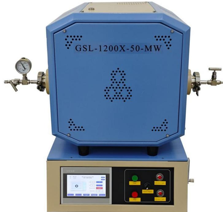
GSL-1200X-50-MW 是一款桌面式，微波管式炉，最高工作温度可达 1100℃，炉管直径为  $\Phi 50\text{mm}$ （可选  $\Phi 25$ ）。设备可设置 30 段升温段，控温精度可达  $\pm 1^\circ\text{C}$ ，可通气氛及高温的实验环境。适用于新材料焙烧实验、锂离子电池正负极材料、稀土材料、催化剂、磁性材料粉体、粉末冶金粉体、有色金属粉末等其他颗粒物的反应、还原、合成等。
